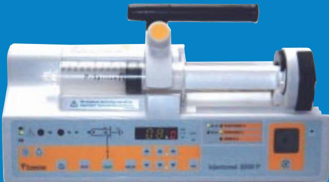
**Injectomat 2000P** ist eine Spritzenpumpe die IV Infusionen mit niedriger Förderrate bei genauer Überwachung des Infusionsdruckes ermöglicht. Die Drucküberwachung durch einen elektronischen Sensor wird permanent angezeigt und ermöglicht sehr kurze Verschlussalarmzeiten.
